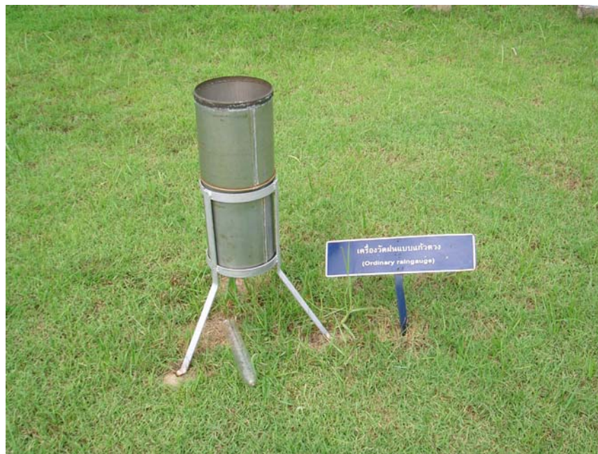
ภาพที่ 9.2 แสดงอุปกรณ์วัดน้ำฝนแบบธรรมดา
